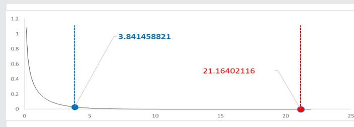
Figura 10 Gráfica prueba 24, de la función inversa de la curva normal para 1 grado de libertad. Fuente: Elaboración propia. (2020)
